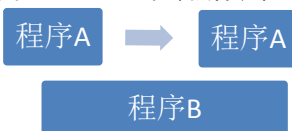
图11-24 RUN 指令执行流程
